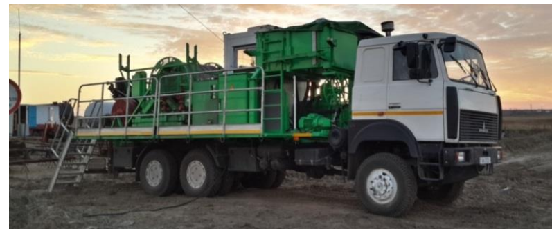
Миникольтовинговая установка для струйного вскрытия пласта
