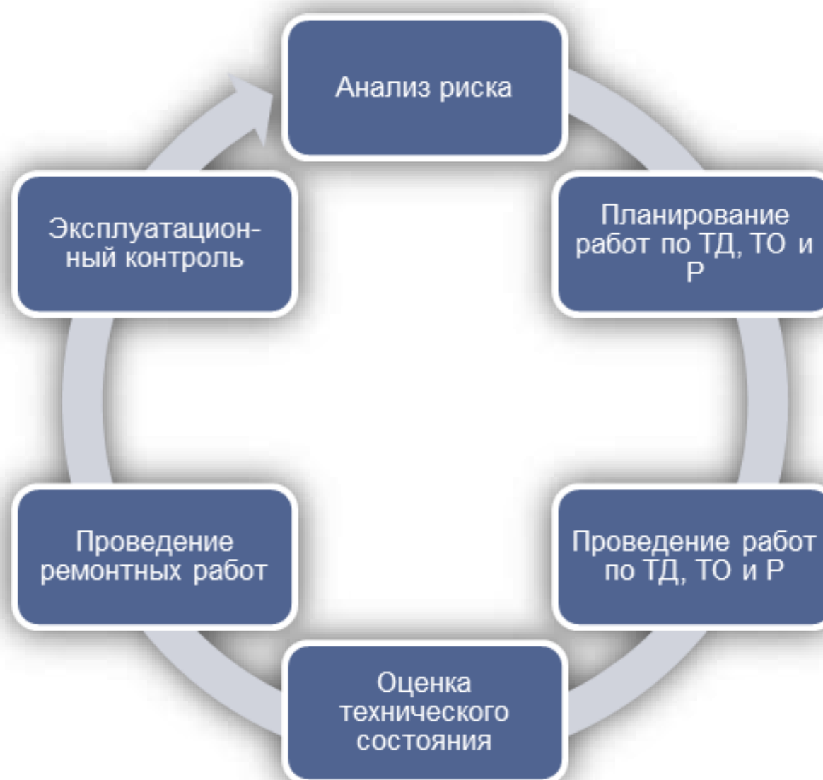
Рисунок 1: Цикл управления целостностью производственных активов
