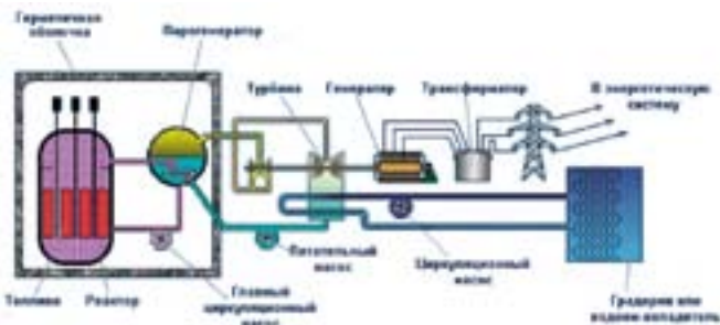
Рисунок 2. Схема атомной электростанции
